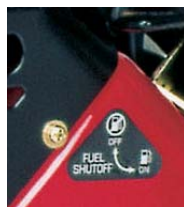
Рис. 4.8: Закрыть топливный кран
