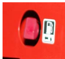
Рис. 4.8: Закрыть топливный кран
