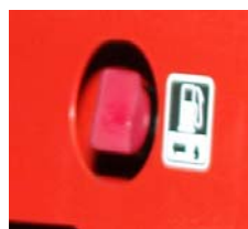
Рис 4.6: Выключение топливного крана
