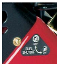
Рис 4.6: Выключение топливного крана
